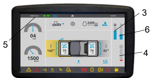
Рис. Отображение состояния 3. Уровень топлива 4. Уровень воды 5. Счётчик моточасов 6. Уровень мочевины
